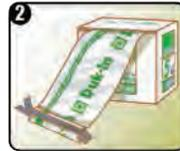
② 残ったN-スプリントのアルミパッケージをクリップします。この際、出来るだけアルミパッケージ内の空気を取り除き、残ったN-スプリントの端を数cm程度折り曲げておきます。
