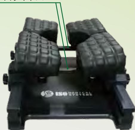
フレーム側面にレントゲンカセット用スペースを設けた手術用架台です。マットは大小2種類あり、患者の体格・体型に合ったものを選択できます。底面のプレートだけでなく、新たに四点支持プレートを支えるスライドバーにもX線透過性に優れた炭素繊維強化プラスチック(CFRP)を採用。内部を中空にしたことで、よりクリアな画像で観察いただけます。
