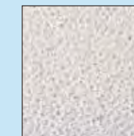
普通のウレタンフォームの断面 (気泡が粗くざらついている)
